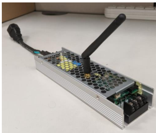
圖 1 BLDC-300 搭配無線模組與外置天線
